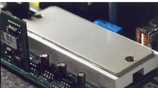
Встроенная тепловая защита в IGBT модулях
